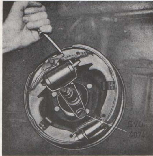
Bild 24. Demont. av hjulcylinder.
