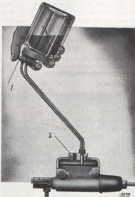
Bild 29. Påfyllning av bromsvätska, tid. uff.
